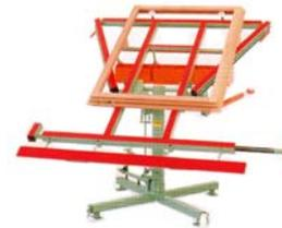
4.4 Вертикальный рабочий стол с поворотным приспособлением служит для остекления окна и его герметизации.
